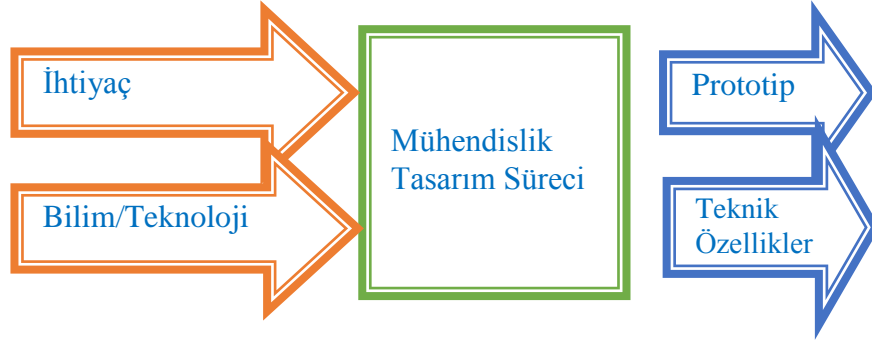
Şekil 4. Mühendisler mühendislik tasarım süreci basamaklarını uygulayarak ihtiyaca/probleme uygun çözümler üretir.
